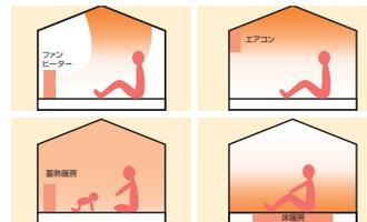
蓄熱暖房器はふく射熱で壁・床・天井を直接暖めるので、ムラなく室内を暖房できる
