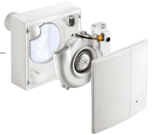
ケースユニット、ファンユニット、フロントパネルで構成され、フロントパネルにはフィルターの掃除時期を知らせるランプがつく
