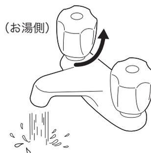
**4** 5分以上流したのち、止水栓を閉じます。電気温水器本体に接続した配管を外します。
