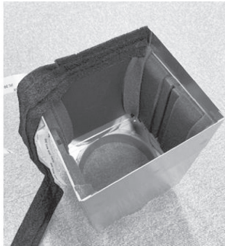
② 短手側から3mm程度、面部からはみ出した位置で始めます。
