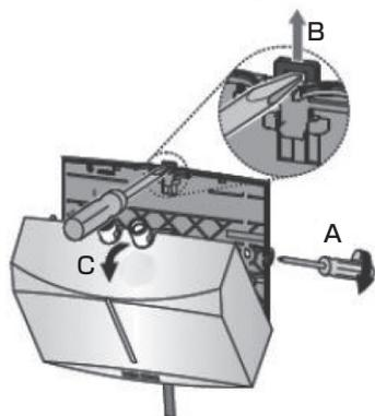
③②の状態のまま、壁固定プレートからヒーティングブロックを手前に引いて外します。
