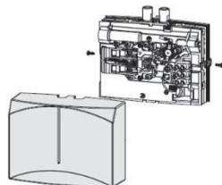
⑥ヒーティングブロック中央下部の温度調整ダイヤルで給湯上限設定を30℃～50℃の範囲で調節します。（初期設定は38℃です。）
