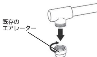
②水栓吐出口が埋め込み式のエアレーター等を使用の場合はエアレーター等を取り外した後、付属のエアレーターを付属のエアレーターハウジング(内ネジM22/外ネジM24)に組み込んでから水栓吐出口に取り付けます。
