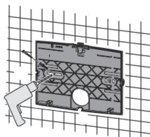
⑤逆転順でストッパー「B」をマイナスドライバーで引き上げつつヒーティングブロックを壁固定プレートに固定します。
